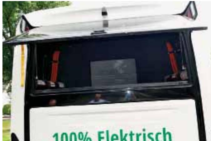
Über dem Motorraum lässt sich eine zusätzliche Klappe öffnen, die überflüssigerweise mit einem Glasfenster versehen ist. Dahinter befindet sich außer zwei großen Fogmaker-Kartuschen nur leerer Raum.
