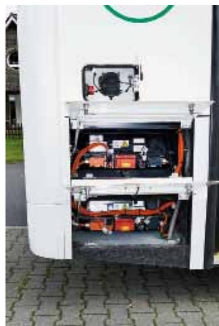
Hinten rechts sind die Ladebuchse und die anderen zwei Batteriepakete übereinander angeordnet.
