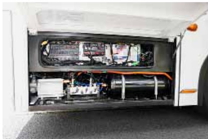
Unter dem Fahrerfenster sind die Lenkhilfpumpe, die Sicherungen und Prüfanschlüsse und ein weiterer Druckbehälter zu finden.
