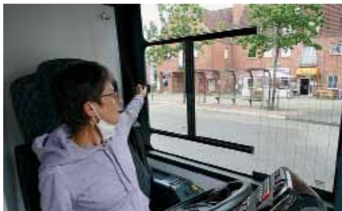
**Zum Öffnen des Schiebefensters muss der Fahrer sehr stark nach hinten greifen, außerdem macht eine so weit hinten angeordnete Öffnung wenig Sinn.**
