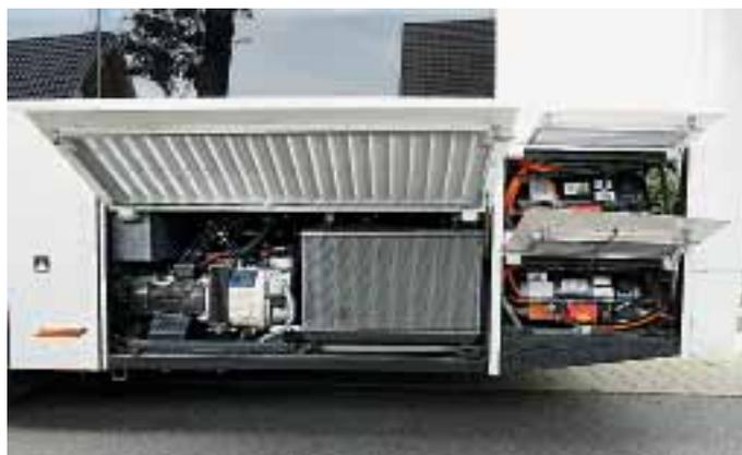
Hinten links sieht man jeweils hinter einer separaten Klappe zwei Batteriepakete mit ihren Hochvoltanschlüssen, die Kühlung und den Luftpresser von Naili.
